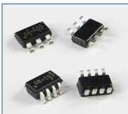
成本最低的封裝中，TSOT23-6 和 SOT23-8 都是很好的選擇。6 腳的封裝對基本降壓轉換器而言是夠用的，而 8 腳的封裝則可提供如軟啟動或 PGOOD 等額外的功能。這些封裝沒有散熱焊盤，所以大部分 IC 的散熱就是透過封裝接腳而到 PCB 的銅線。
